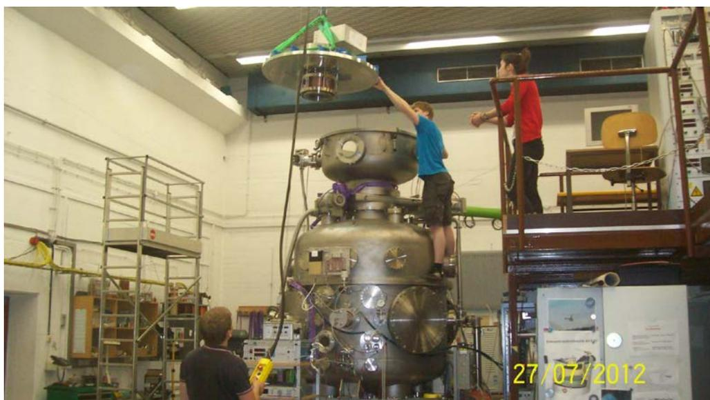
**Рис.6. Монтаж ВЧ источника ионов RIM-20 для демонстрационных испытаний в Гиссене**
