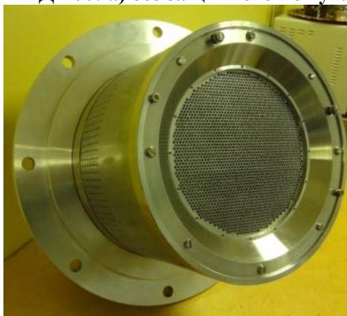
Рис.5. Лабораторная модель ВЧИД-15
