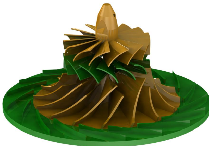
Рис. 4 3D модель малоразмерного осецентрибежного компрессора.
