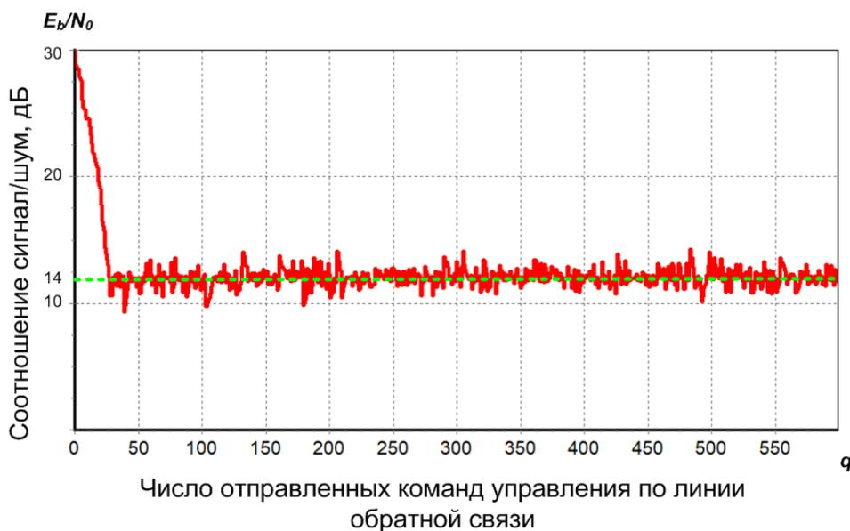
Рис. 6. Зависимость значений  $E_b/N_0$  и числа отправленных команд управления по линии обратной связи
