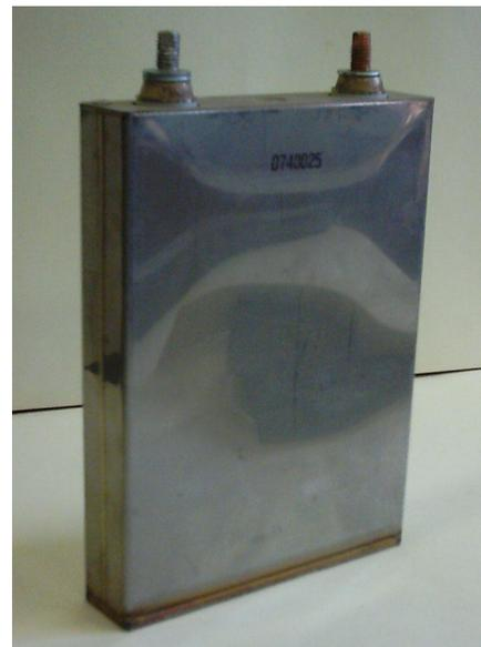
Рис. 7. Вид аккумулятора после проведения короткого замыкания
