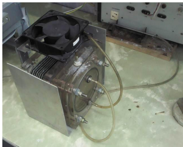
Рис.4 Установка для пайки водородным пламенем
