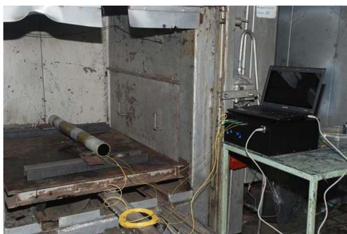
Рисунок 3. Корпус в печи для полимеризации с подключенным оборудованием для регистрации показаний оптического волокна.
