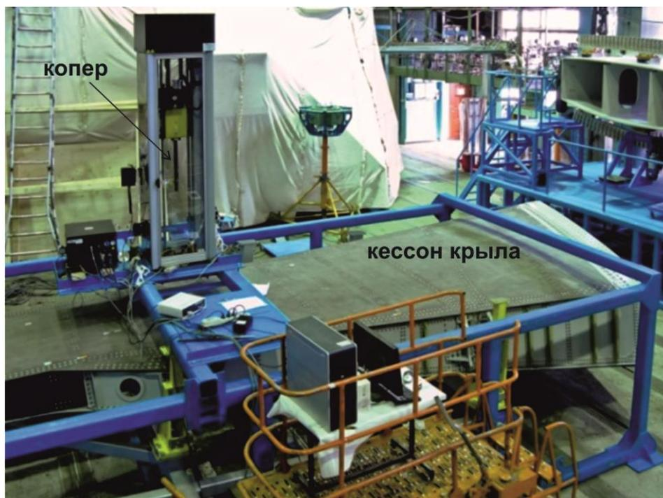
Рисунок 1 – Нанесение нормированных ударных повреждений на натурную конструкцию композитного крыла магистрального самолета
