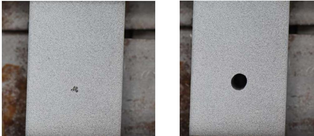
Рис. 4. Образец стали, изготовленный по технологии 3д печати, до и после нанесения зондирующего отверстия.
