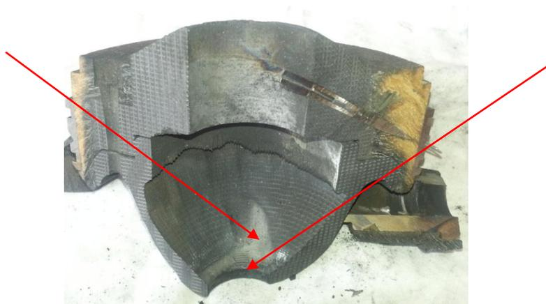
**Рис. 5.** Фото внутренней поверхности двухкаскадного регулятора расхода маршевого топлива из УУКМ для РПДТ при исследовании теплоэрозионного (абляционного) уноса углеродного материала
