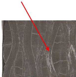
**Рис. 7** Фото микроструктуры УККМ, где показан процесс насыщения в объеме пористой заготовки УУКМ матрицей из карбида кремния SiC (белая фаза)
