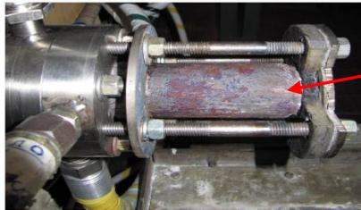
Срез модельной втулки (критика), диаметр критики  $d=40\text{мм}$
