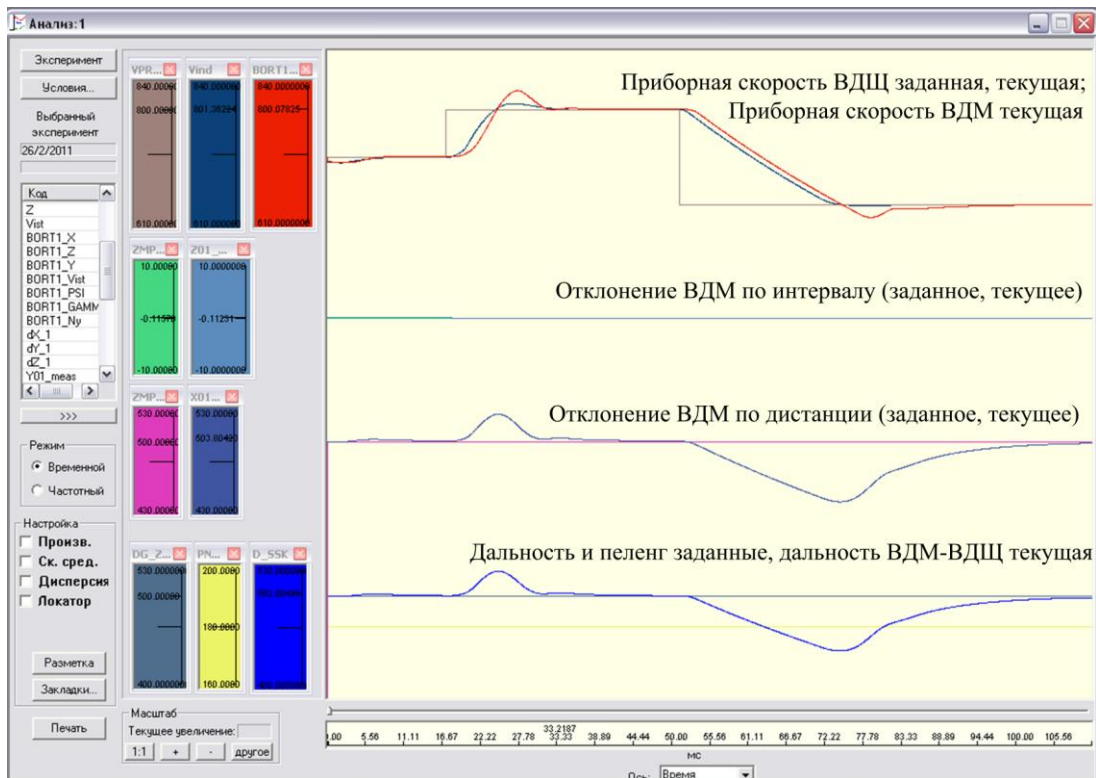
Рисунок 9. Позиционные сигналы рассогласования текущего положения ВДМ самолета и заданного положения при выполнении маневра по скорости (разгон-торможение)
