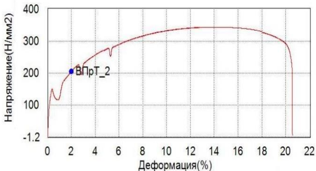
Рисунок 11 - Изменение кривой напряжения-деформации образца при 50°C.
