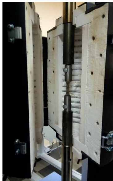
Рисунок 9 - Экспериментальная установка SHIMADZU TCE-N300 с термостатической камерой.
