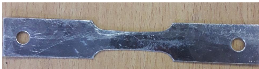
Рисунок 7 - Образца оболочки из сплава стали X17 (Лист тонкий - ГОСТ 5582-75).
