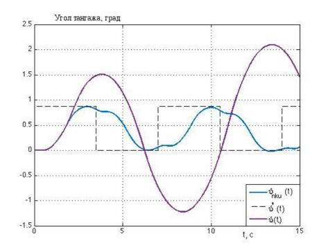
Рис. 2 – Переходные процессы по тангажу оптимальной системы с ПКУ и без
