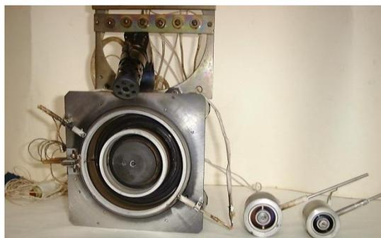
**Рис.3. Фото лабораторных моделей СПД-
