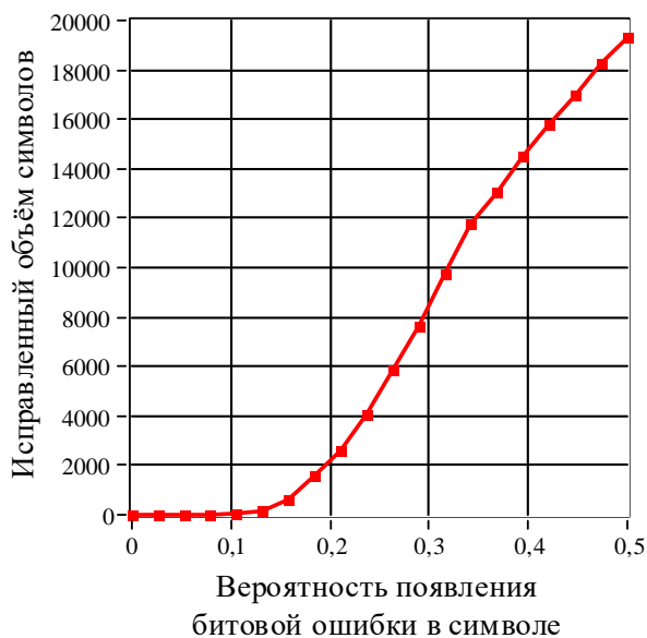
Рисунок 21 – Зависимость объема исправленных символов от вероятности появления битовой ошибки
