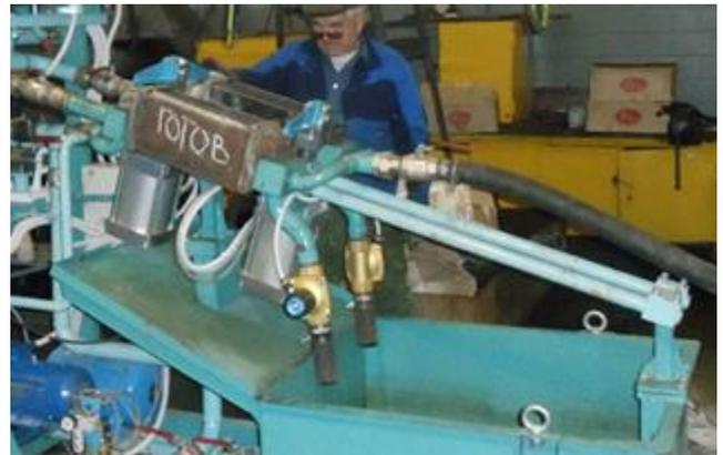
Рисунок 10 – Стенд СП-С1 для промывки радиаторных секций
