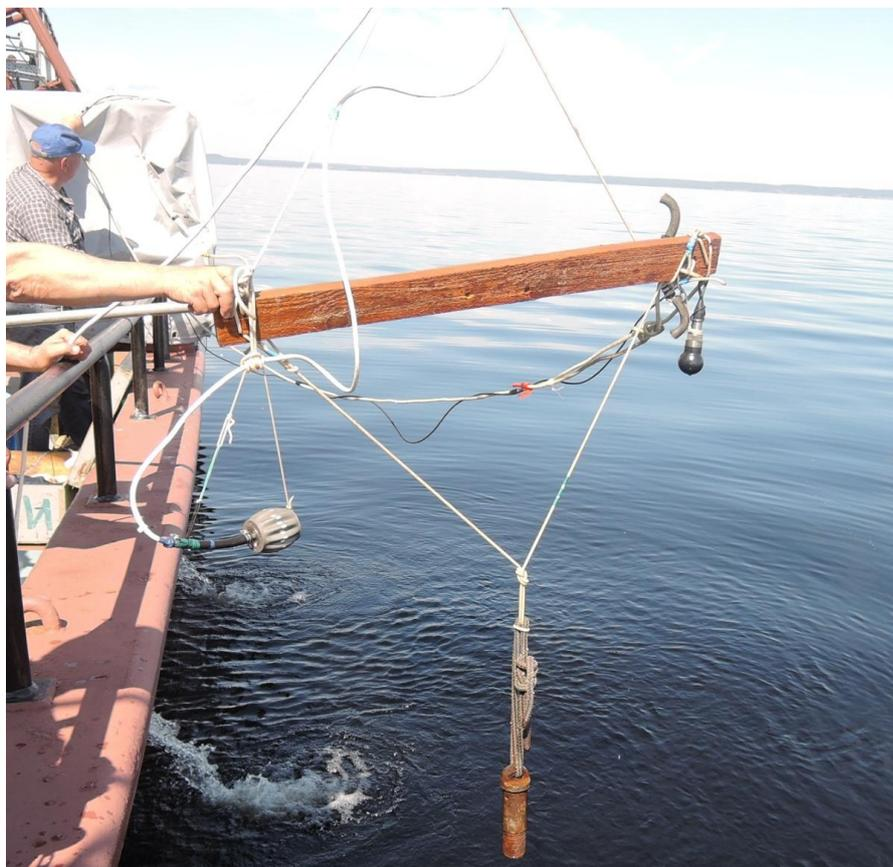
Рис. 9. Излучатель с закреплённым гидрофоном и грузом-заглубителем перед погружением для измерения электроакустических параметров в открытой воде.
