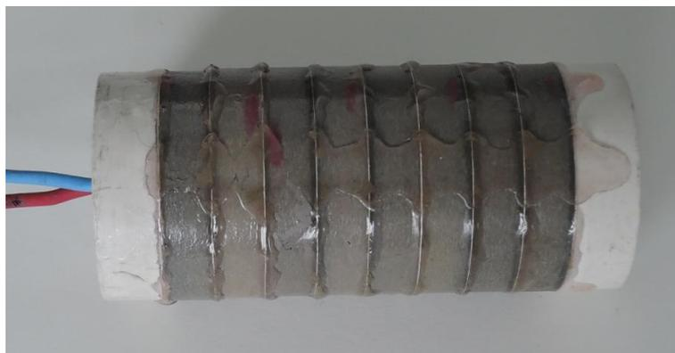
Рис. 8. Активный элемент излучателя, собранный из 8 пьезокерамических колец.
