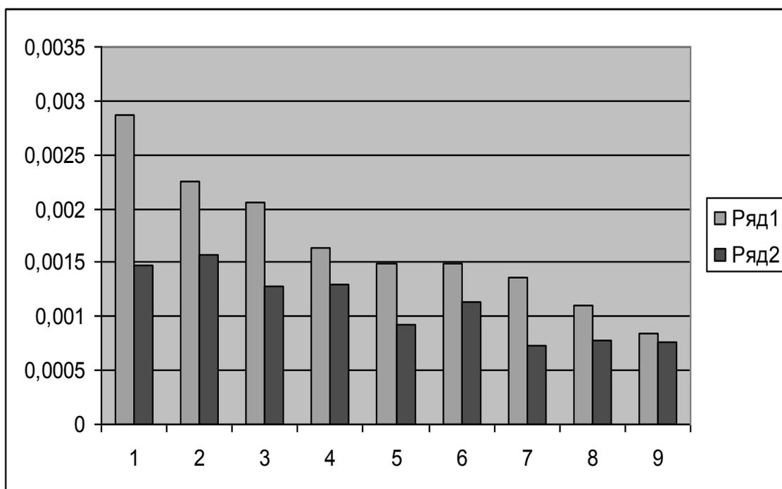
**Рис. 4.** Графическое сравнение элементов первого ряда двумерного распределения очереди трафика натурной и смоделированной трассы *лок.2* ( $\rho=0,4 \Delta t = 1000$ )
