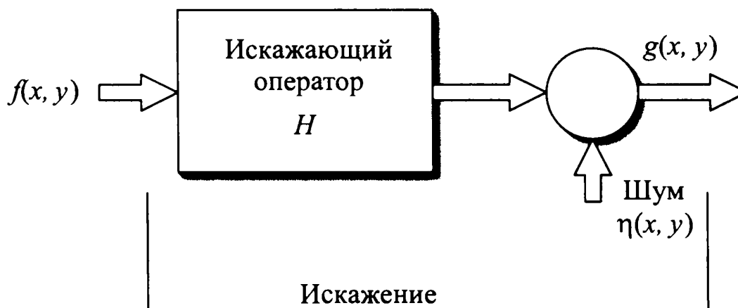
Рисунок 8 – Моделирование процесса искажения изображения
