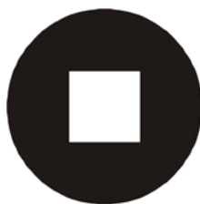
Рисунок 7 - Миря для измерения SiTF(T) , 3D-шума \sigma(T) и ЧКХ MTF_{lab}(\xi, \eta)
