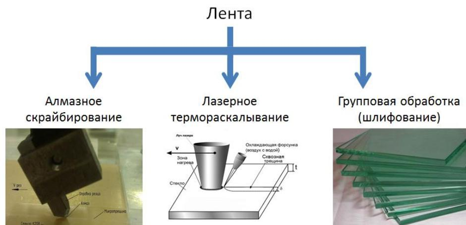
Рисунок 5. Резка ленты на стеклоэлементы
