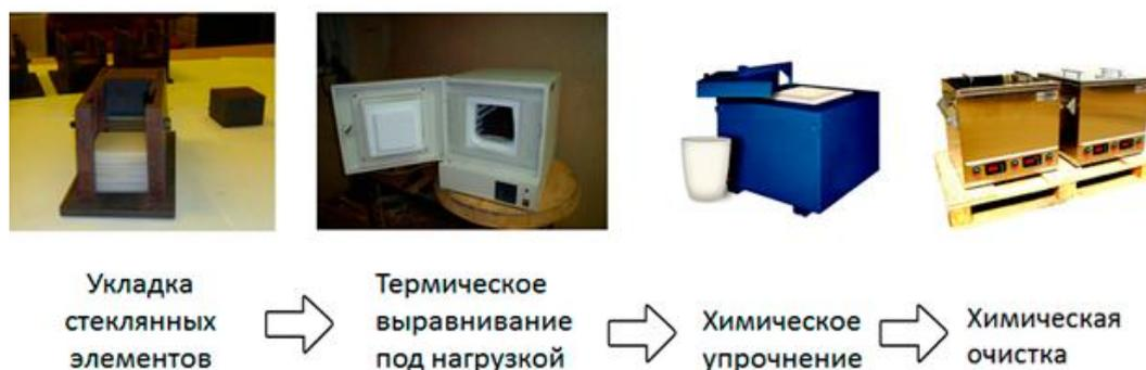
Рисунок 6. Выравнивание, химическое упрочнение и очистка
