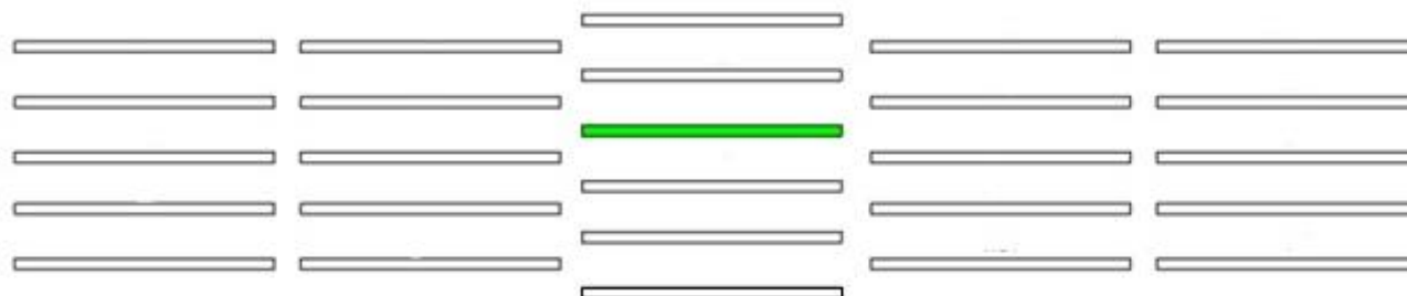
Рисунок 12 – Эскиз расположения силовых ключей в основании прибора. Зеленым цветом обозначена плата, на которую устанавливаются термопары. Вид сверху.
