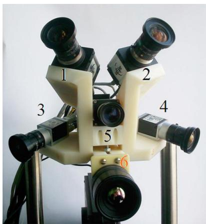
Рис. 3. Вид макета ОЭСПТ с нумерацией камер
