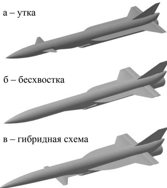
**Рис. 5. Разработанные аэродинамические компоновки сверхзвукового БЛА**
