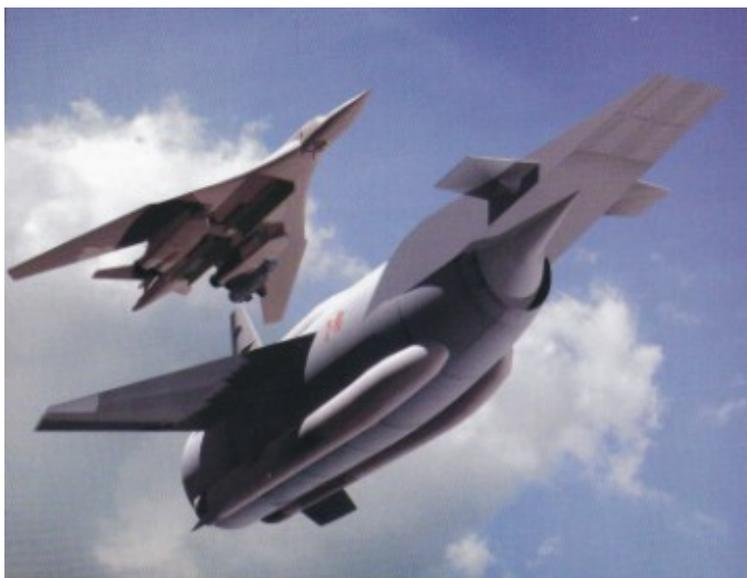
**Рис. 3. Крылатая ракета X-90 с лобовым аэродинамическим экраном**
