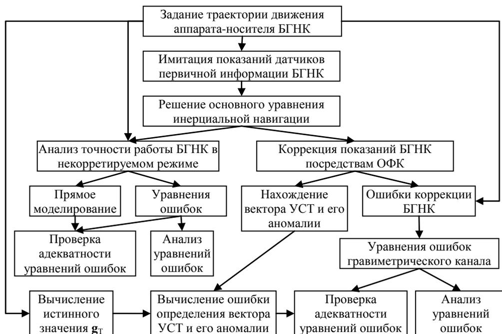
Рисунок 2 – Блок-схема имитационного моделирования работы БГНК
