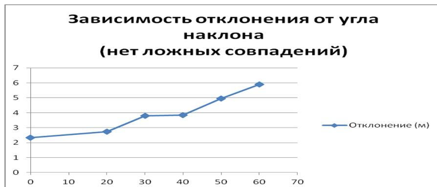
Рис. 14 – Зависимость средней величины отклонения от угла наклона входного снимка (нет ложных совпадений)
