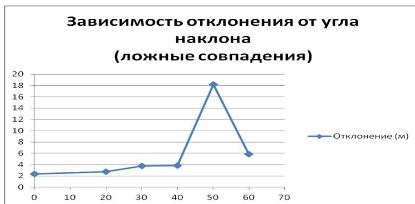
Рис. 15 – Зависимость средней величины отклонения от угла наклона входного снимка (ложные совпадения)
