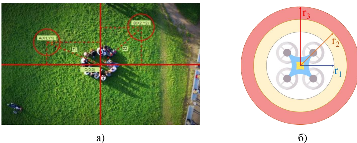
Рис. 5. Зоны-кандидаты аварийной посадки БПЛА: а) Измерение расстояний до потенциальных зон посадки; б) Зоны обнаружения препятствий для потенциальных зон посадки
