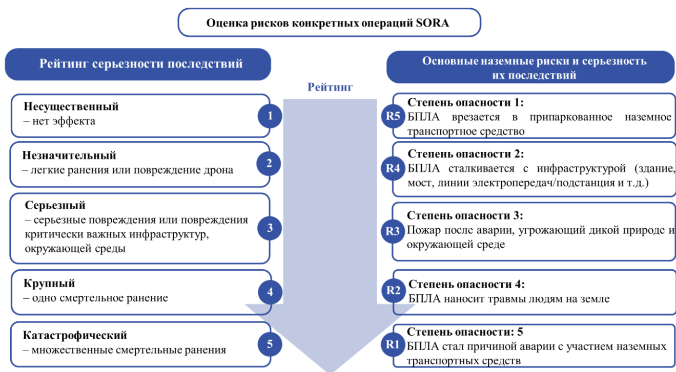
Рис. 1. Соответствие рейтинга и последствий аварийных посадок согласно стандарту SORA
