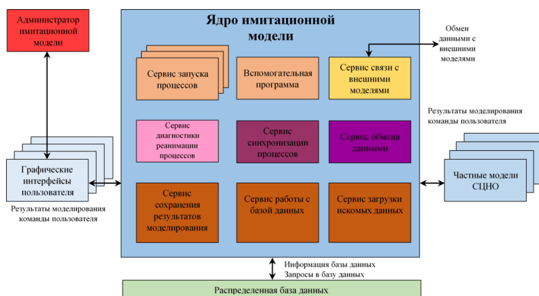
Рисунок 2 – Структура имитационной части метеорологического радиолокационного комплекса
