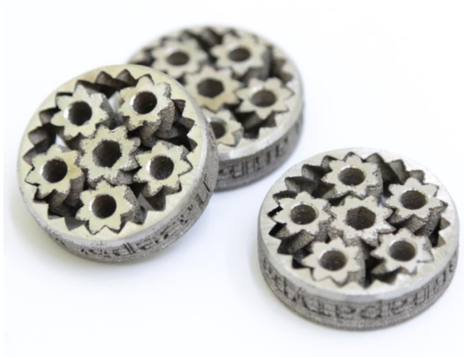
Рис.3. Составная конструкция сложной геометрии, созданная на МЛ6.
