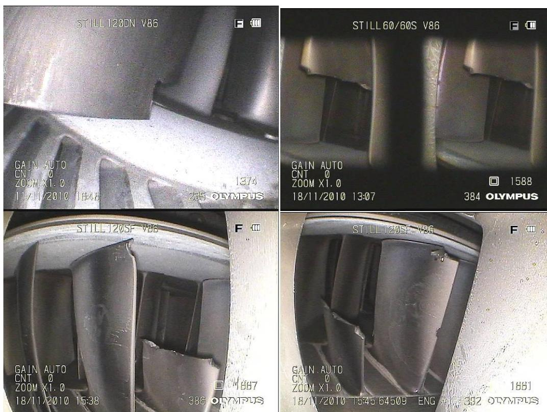
Рис. 1. Поломки лопаток различных ступеней двигателей гражданской авиации
