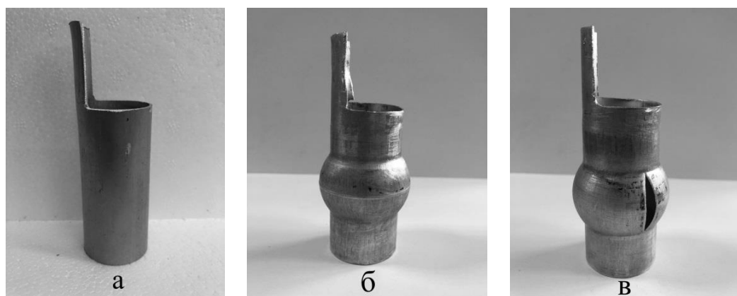
Рис. 5. Испытательные образцы из алюминиевого сплава Д16: а) образцы до проведения эксперимента, б) деформированные образцы в) разрушенные при деформировании образцы.
