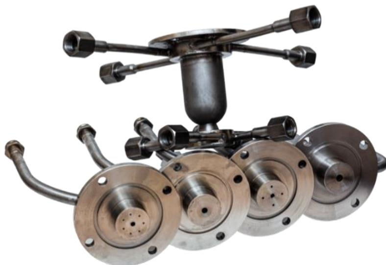
Рисунок 5 – Опытный образец ЖРД малой тяги со смесительными элементами
