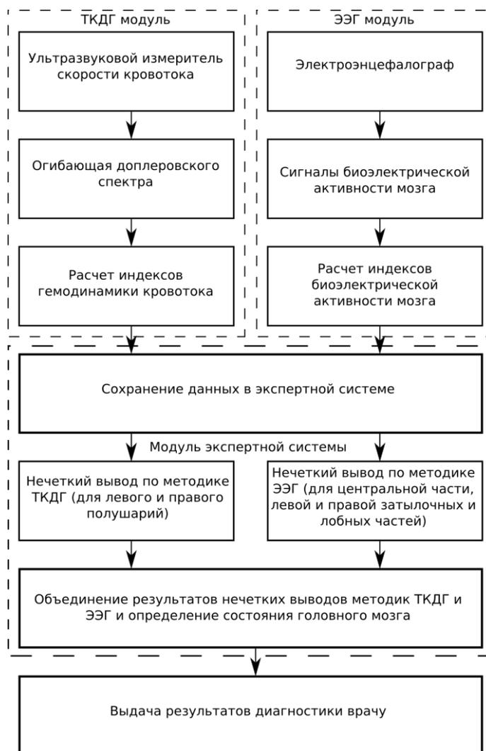
Рис. 2. Схема процесса диагностики состояния мозга с помощью методик ТКДГ и ЭЭГ
