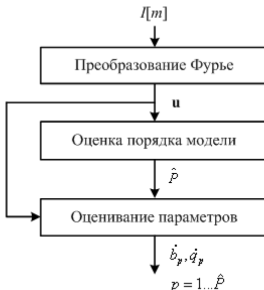
Рис. 3. Схема алгоритма параметрической обработки.
