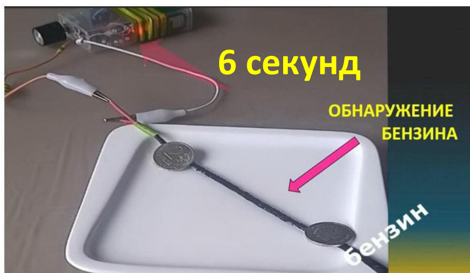
Рис. 4. Время реакции отечественного сенсора углеводородов на бензин
