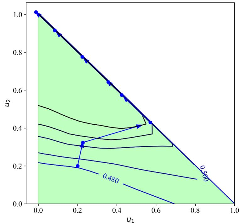
Рисунок 8. Иллюстрация пошаговой работы алгоритма по достижению оптимального управления
