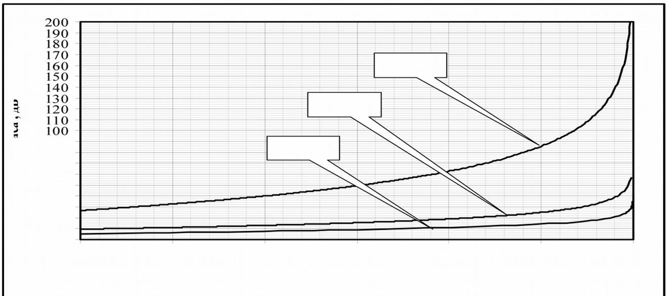
Рис.2. Коэффициент запаса в дБ в зависимости от надёжности связи для случаев  $\sigma_2 = 10\text{дБ}$ ,  $\sigma_2 = 6\text{дБ}$ ,  $\sigma_2 = 3\text{дБ}$  и соответственно таблица 5.
