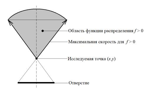
Рис. 6. Схема образования функции распределения в исследуемой точке
