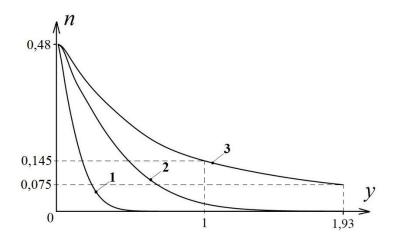
Рис. 11. Эволюция распределения концентрации компонент газа по оси y (x = 1)
