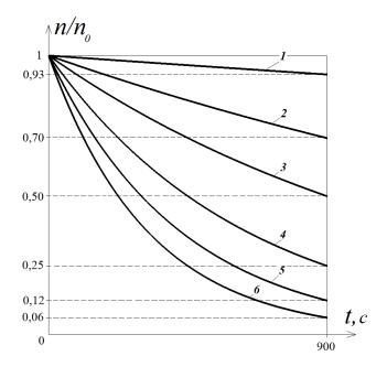
Рис. 15. Зависимость концентрации в резервуаре от времени по формуле (11)
