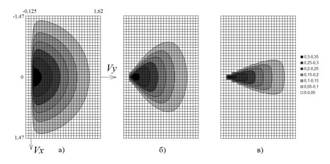
Рис. 4. Изолинии функции распределения частиц газа в зависимости от координаты
