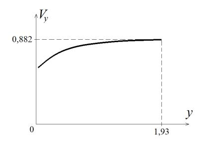
Рис. 7. Зависимость средних скоростей частиц от координаты y вдоль оси симметрии струи (t=10)
