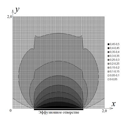
Рис. 10. Изолинии концентраций частиц газа в расчетной области (t = 10)
