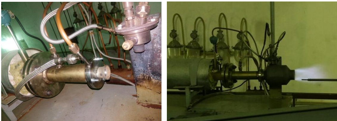
Рис.3 Размещение форсунки в имитаторе жаровой трубы
