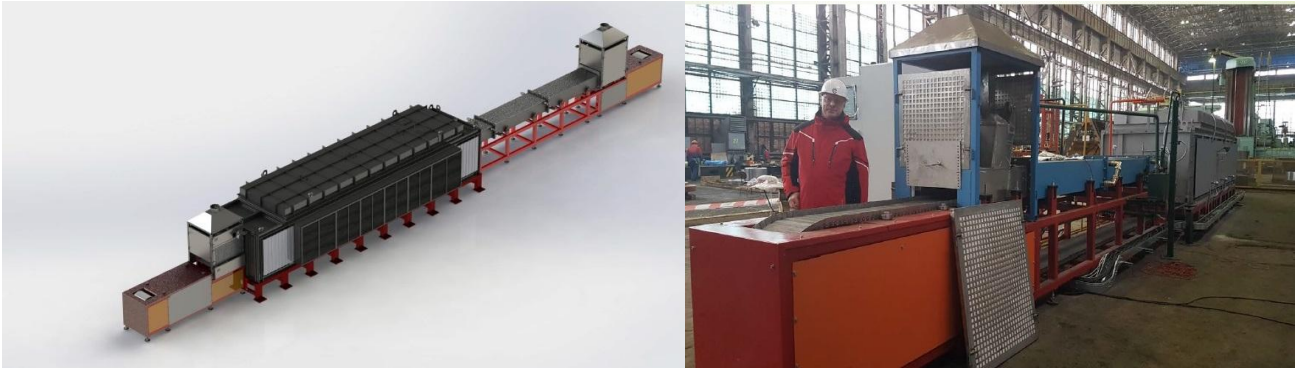
Рисунок 2 – Проходная печь отжига безокислительного нагрева
