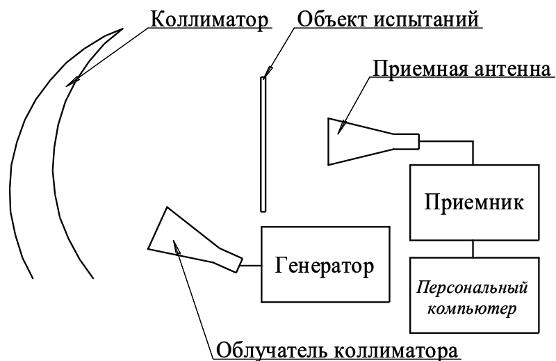
Рисунок 2 — Схема рабочего места в БЭК с коллиматором
