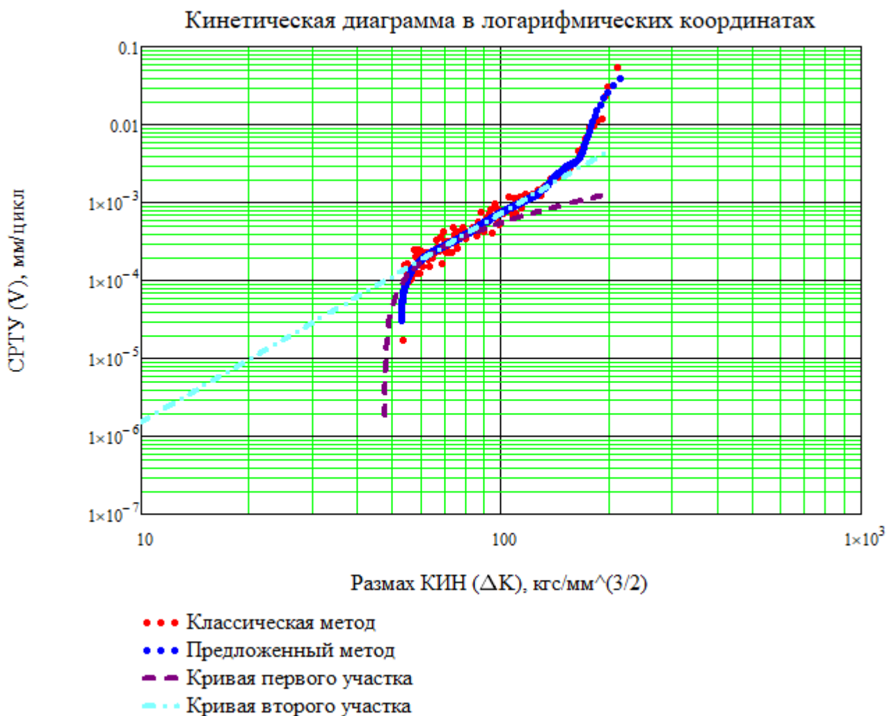
Рисунок 14 – Типичный вид кривых (1) – светлоголубым; и (12) – фиолетовым; на фоне экспериментальной зависимости СРТУ от размаха КИН, полученной классическим и предложенными методами
