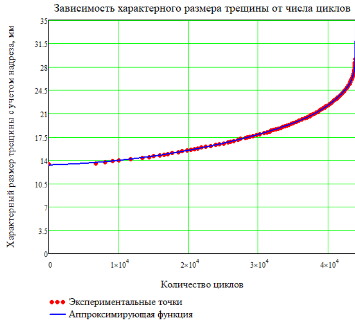
Рисунок 8 – Типичный вид приближения исходных данных при помощи функции вида (9)
