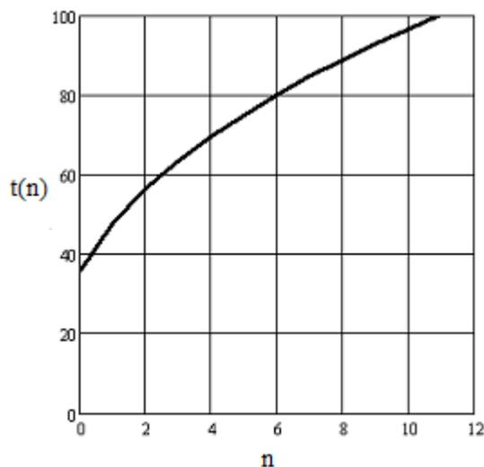
Рис. 7 Зависимость времени замен  $t(n)$  от числа циклов  $(n)$ .
