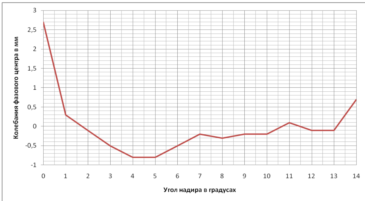
Рисунок 5. Вариации фазовых центров для антенн спутников ГЛОНАСС (SVN 711, 783, 787-789, 791-798) и ГЛОНАСС-М (SVN 701, 712-735). Источник: файл “igs05_1585.atx” (28 мая 2010г.)
