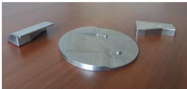
Рис.12 - Подштаповая плита, подвижный прижим и оснастка для детали №2
