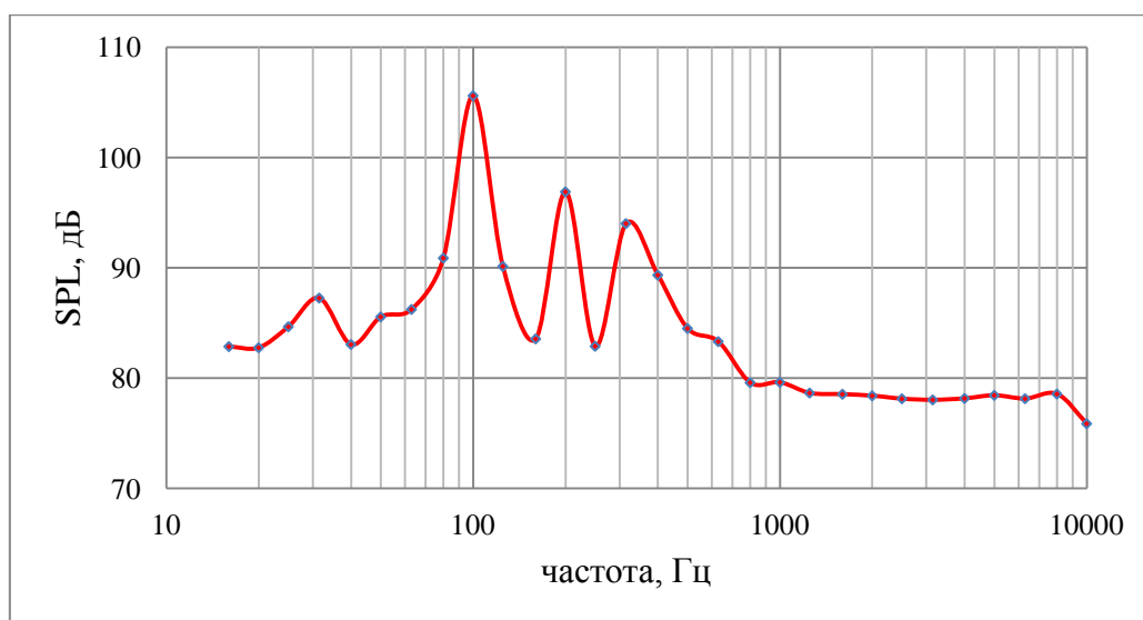
Рисунок 8 - Третьоктавный спектр акустического излучения силовой установки самолета «Ан-2» в диапазоне частот 16-10000 Гц (Режим 6, \varphi=120^\circ )
