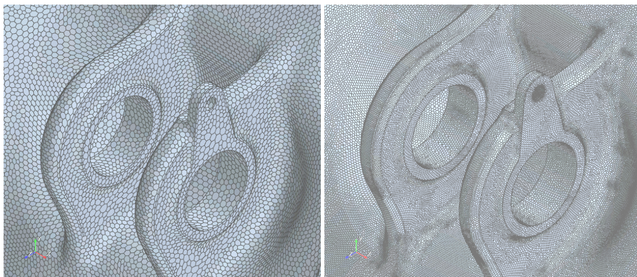
Рисунок 4 - Фрагменты конечно-объёмных сеток ЗСУ
