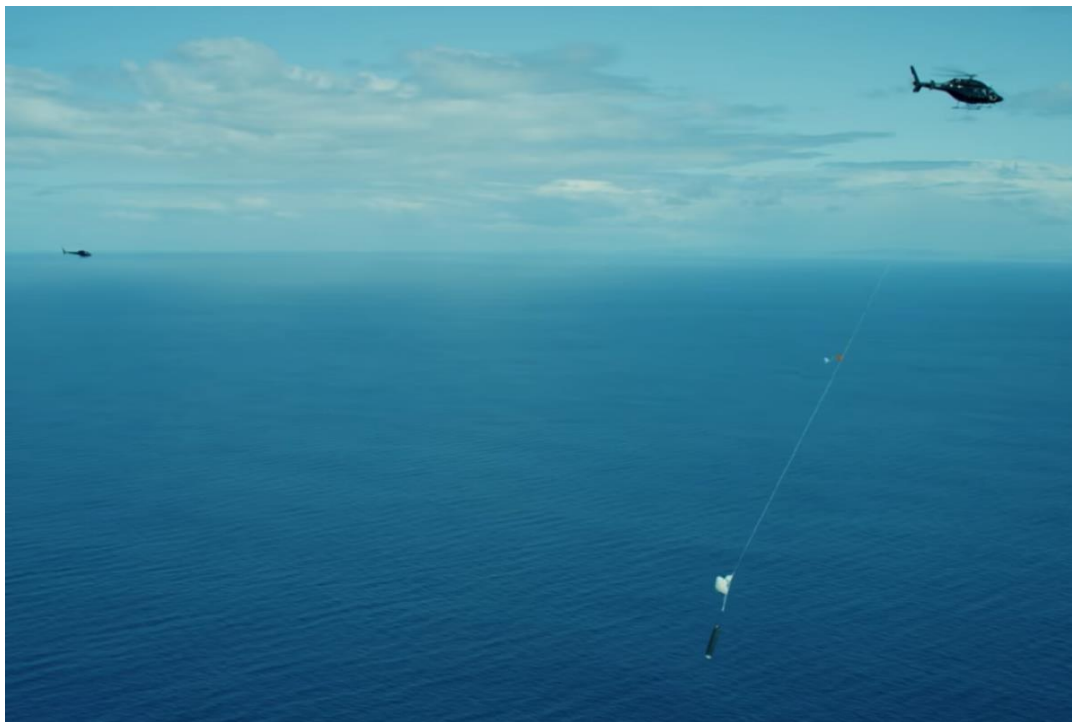
Рис. 2. Вертолетный подхват парашютирующего возвращаемой первой ступени компании «Rocket Lab».
