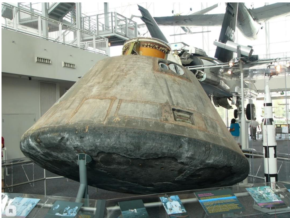
Рис. 1. Обгорание абляционного защитного покрытия.
