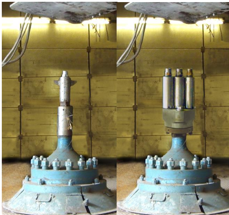
Рис. 2 Вид установки с различными вариантами компоновки сопел (слева – одиночная струя, справа – трехблочная струя)
