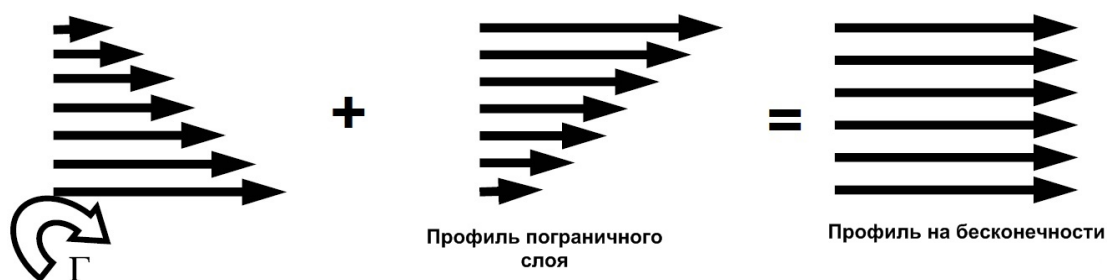
Рис. 2. Концепция создания равномерного профиля вблизи экрана
