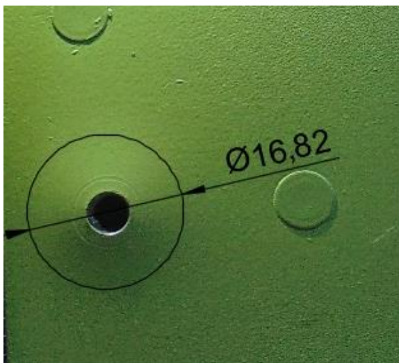
Рисунок 1 – Примеры случайных дефектов в обшивке самолета
