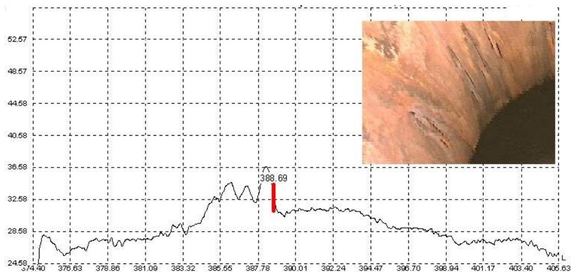
Рисунок 5 - Спектр излучения при наличии пролизов и прогаров камеры сгорания
